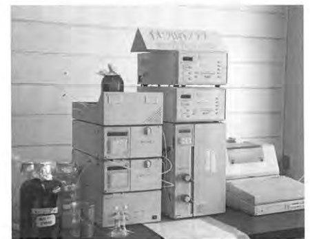
イオンクロマトグラフ 水中の陽イオン・陰イオンの分析
