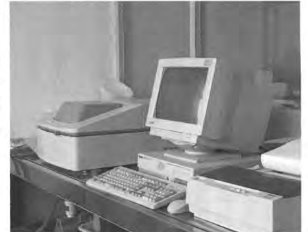
蛍光X線分析 周期表のNaからUまでの元素分析
