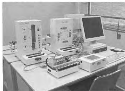
PLC（シーケンサ）実習装置 エレベータや信号機の制御を模型を使って勉強できます。
