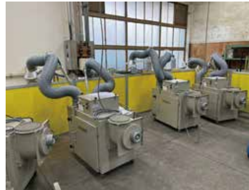
溶接ヒューム集塵機
